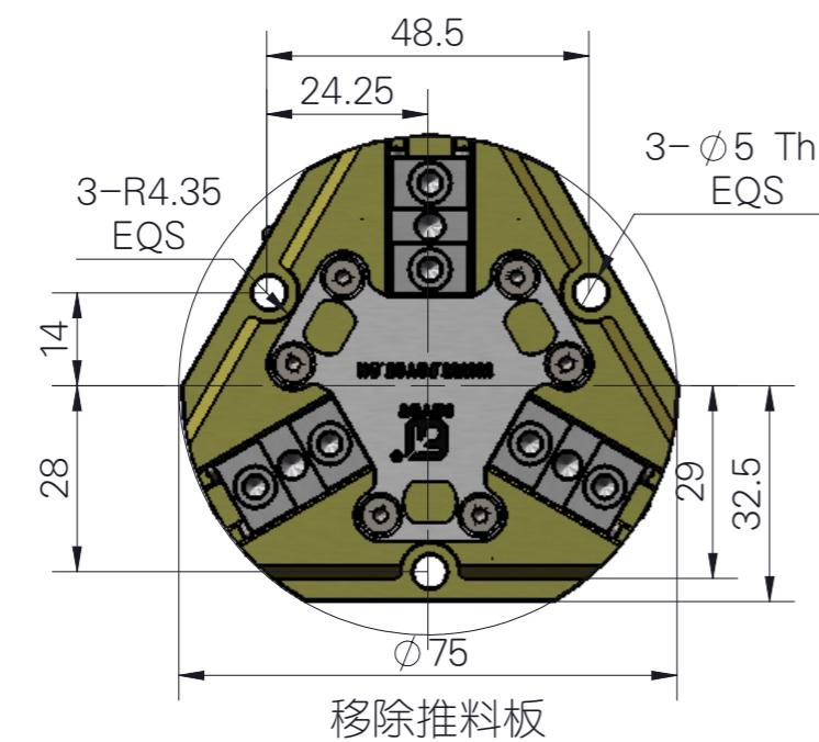
推荐的工作重量 (Recommended workpiece weight) : 2.9kg
